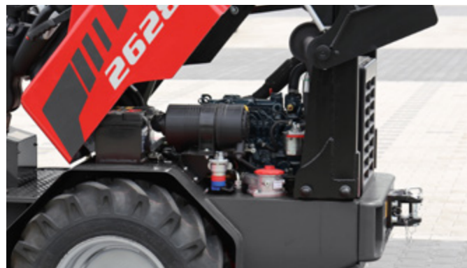
Pokrywa silnika otwiera się do przodu, dzięki temu wszystkie czynności serwisowe można wykonać z łatwym dostępem.
