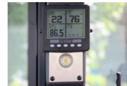
Nowy wyświetlacz informacyjny w kolumnie kabiny dla monitorowania spalin
