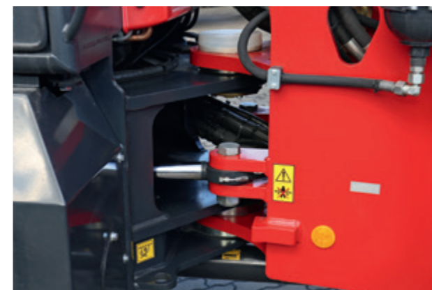
Przegub jest bardzo mocny i bezostługowy. Siłowniki skrętu zapewniają doskonałą kontrolę.
