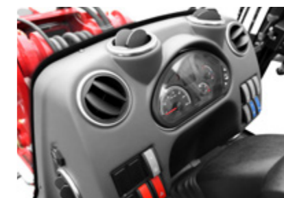
Dodatkowe wyloty powietrza dla idealnej cyrkulacji powietrza
