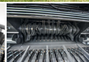
Rotor XtraCut13 (odległość między palcami: 90 mm) - Bez mechanizmu tnącego (seryjnie) - Z listwą tnącą: do 13 noży
