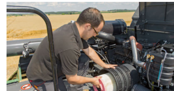
Czyszczenie filtra powietrza
