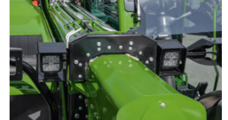
Oświetlenie LED na ramieniu teleskopowym
