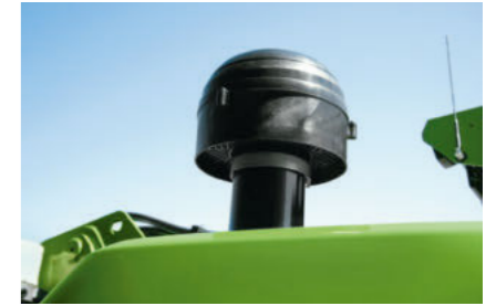
• Wstępny separator cyklonowy dla filtra powietrza (stopień separacji 98%)
