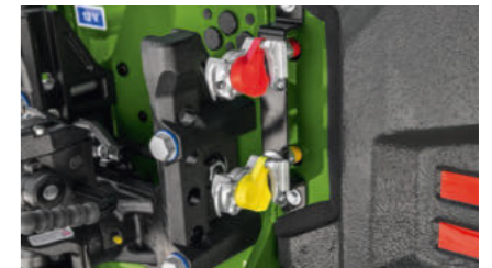
Nadwozie – Opcje • Układ hamulcowy pneumatyczny
