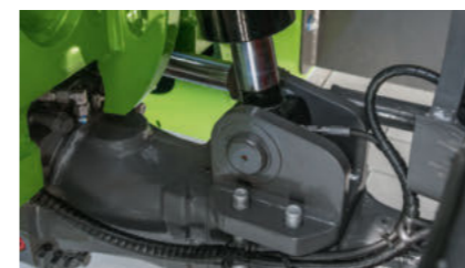
Podwozie – Opcje Blokada osi wahadłowej osi tylnej • Funkcja 1: swobodnie wahliva • Funkcja 2: automatyczna blokada przy zatrzymaniu • Funkcja 3: trwale zablokowana
