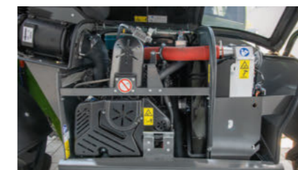
Chłodzenie – Opcje • Wentylator z rewersem • Aktywacja automatyczna w 3 odstępach czasowych (20, 40 lub 60 minut) lub załączenie ręczne przyciskiem.
