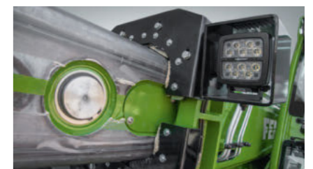
Zgarniacz zanieczyszczeń wysięgnika • Zapobiega wnikaniiu zanieczyszczeń do wnętrza wysięgnika teleskopowego i uszkodzeniom
