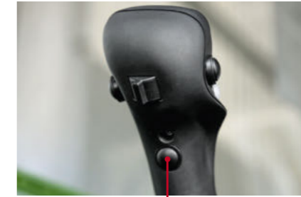
Funkcja Recall memo dla wysokości kabiny
