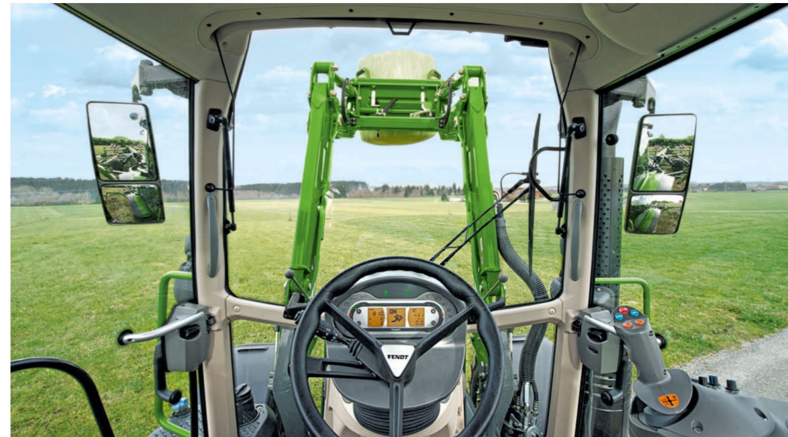
Wyjątkowa, zaokrąglona szyba przednia ciągnika zapewnia świetny widok całkowicie wysuniętego osprzętu. Jednocześnie wyprofilowanie szyby zapobiega gromadzeniu się materiału na niej, zapewniając zawsze idealną widoczność.
