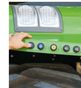
Podnośnik tylny, WOM i moduł sterowania można dogodnie obsługiwać z błotników tylnych.
