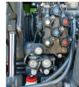
Podłączenia hydrauliczne są oznaczone kolorystycznie. W ten sposób można szybko i bezpiecznie podłączyć urządzenia.
