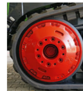
Przednie rolki pośredniczące mogą być dociążone nawet do 1 580 kg.
