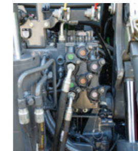
Układ hydrauliczny zaprojektowany jest pod kątem maksymalnej wydajności i oferuje opcjonalny wydatek sięgający 440 l/min przy prędkości obrotowej 1 700 obr./min.
