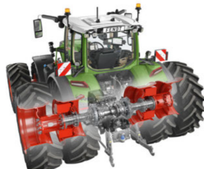
Tylna oś rozsuwana 3000 mm z kołami bliźniaczymi i piastą z dwoma kołami
