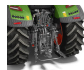
Tylny TUZ z końcówkami kulowymi i blokami gumowymi
