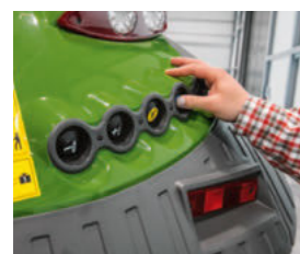
Tylny podnośnik, WOM i jeden zawór hydrauliczny mogą być obsługiwane z jednego z błotników tylnych.
