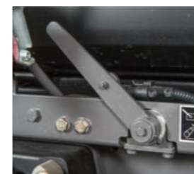
Zapobiega nieprawidłowemu użytkowaniu i uszkodzeniu użytkownika i uszkodzeniu podłączonego osprzętu: ramiona dolne należy zabezpieczyć zaworem odcinającym.
