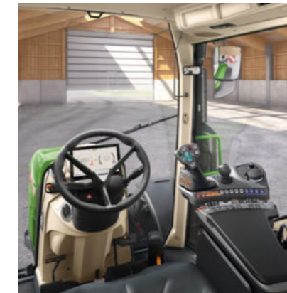
Profi Setting 1 - Dźwignia krzyżowa - 1 moduł liniowy (przełącznik kołyskowy) do sterowania zaworami hydraulicznymi
