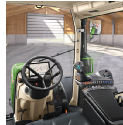
Power Setting 1 - Brak dźwigni krzyżowej - 1 moduł liniowy (przełącznik kołyskowy) do sterowania zaworami hydraulicznymi
