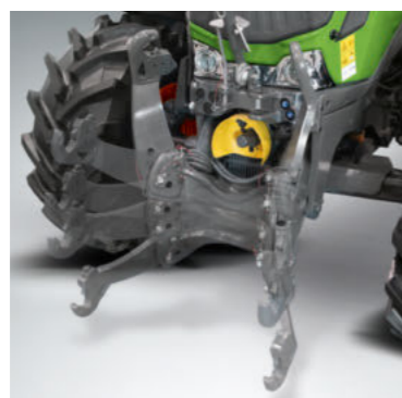
Tylny podnośnik, WOM i jeden zawór hydrauliczny mogą być obsługiwane z jednego z błotników tylnych.
