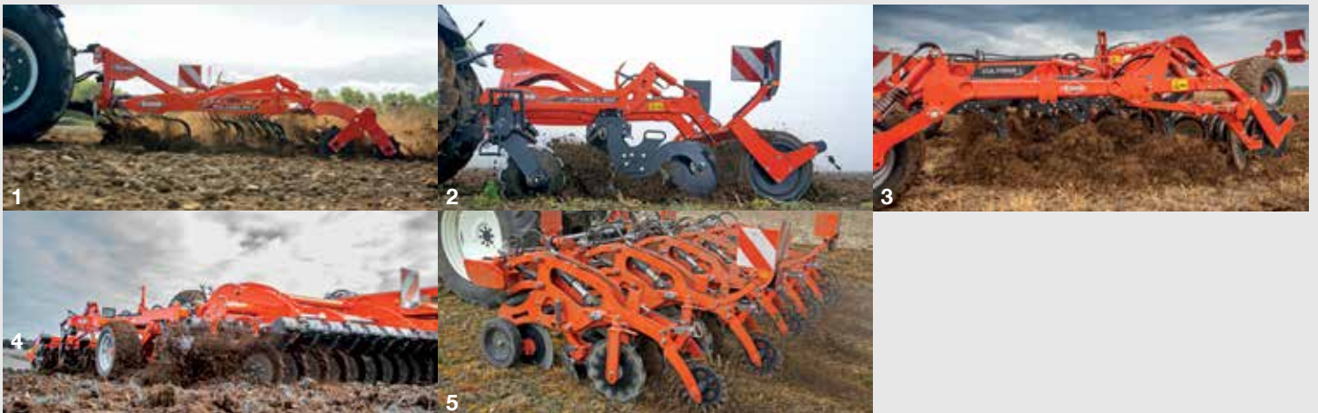
1. Kultywator ze sprężystymi zębami - 2. Brona talerzowa z niezależnie montowanymi talerzami OPTIMER - 3. Kultywator zębowy CULTIMER 4. Kultywator zębowo-talerzowy PERFORMER - 5. Kultywator do uprawy pasowej STRIGER 100
