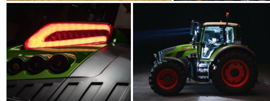
Nowe tylne światła LED (kompatybilne z CAN) z dynamicznym kierunkowskazem
